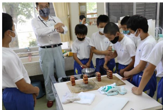
溶けた金属を鋳型に入れて冷ましています。
