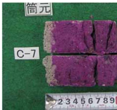
写真-2.8 中性化試験状況
