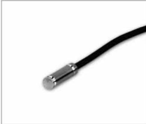
内部の受感素子に特殊温度ゲージを用いた温度計です。防水性が高く、コンクリートや土中への埋込に適しています。施工管理や安全管理において温度管理が重要な測定に用いられます。4ゲージブリッジ法を使用していますので、通常のひずみ測定器で簡単に相対温度の測定ができるだけでなく、インシャル値入力ができる測定器に温度計の添付データ(ゼロバランス値)を入力することにより実温度の測定もできます。
