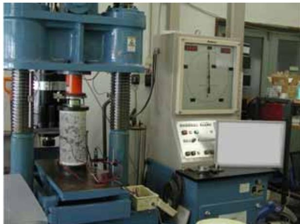
写真-2.7 一軸圧縮強度試験装置外観
