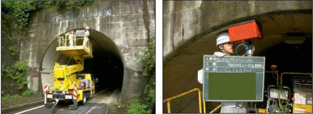
写真-2.4 覆工レーダー探査状況
