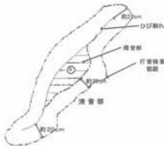
図-3.2 打音検査範囲の模式図
