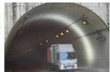
写真-1.2 走行型計測撮影状況
