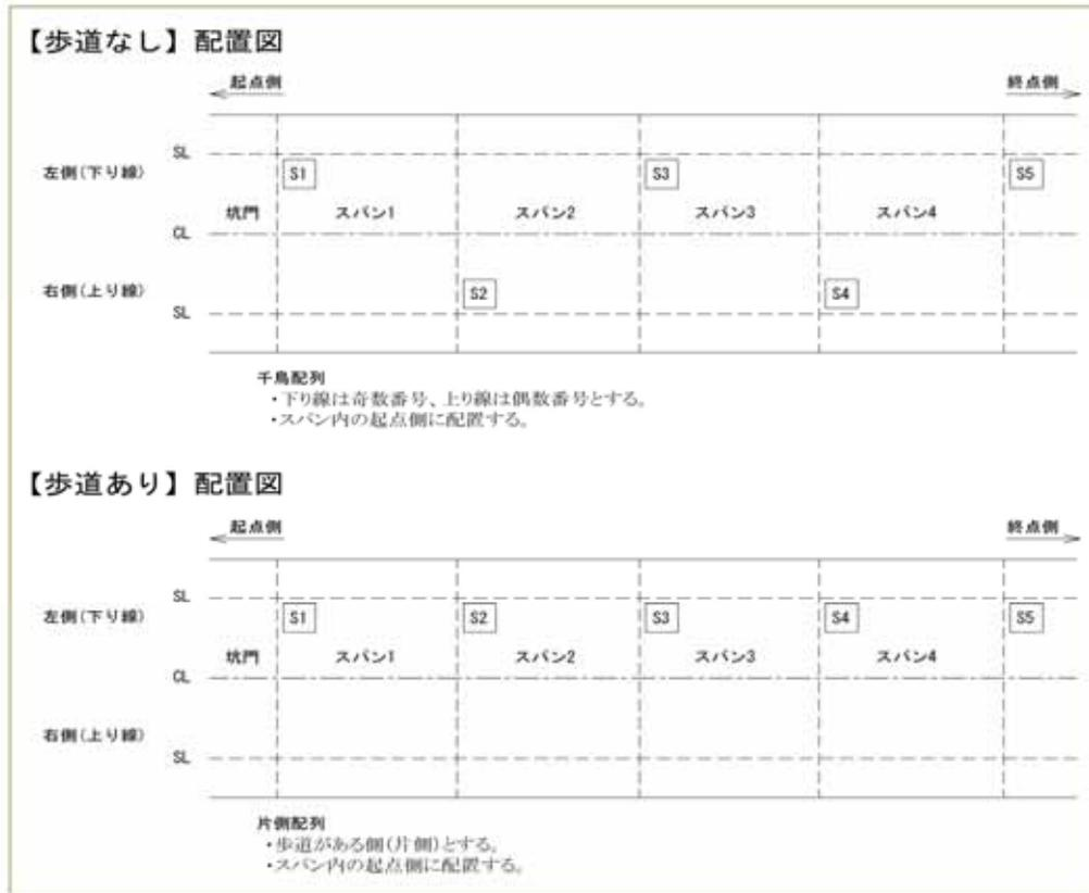
⑤建設年次の古いトンネルで、坑門と一体化している覆工スパン、もしくは、坑門直近に横断目地を有する(2-3m 程度以内が目安)場合は、起点側(PS)、終点側(PE)とする。
