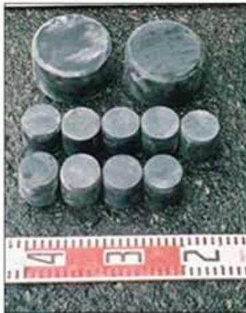
写真-2.3 水膨張性止水ゴム
