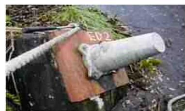
写真 2.34 防錆油の流出痕跡
