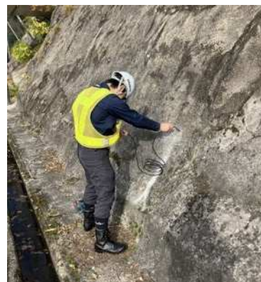
写真 1.7 ファイバースコープによる調査
