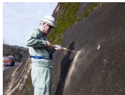
写真 1.5 土壌硬度計による調査
