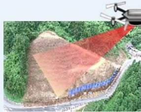
ドローンによる3D測量
