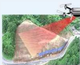
ドローンによる3D測量
