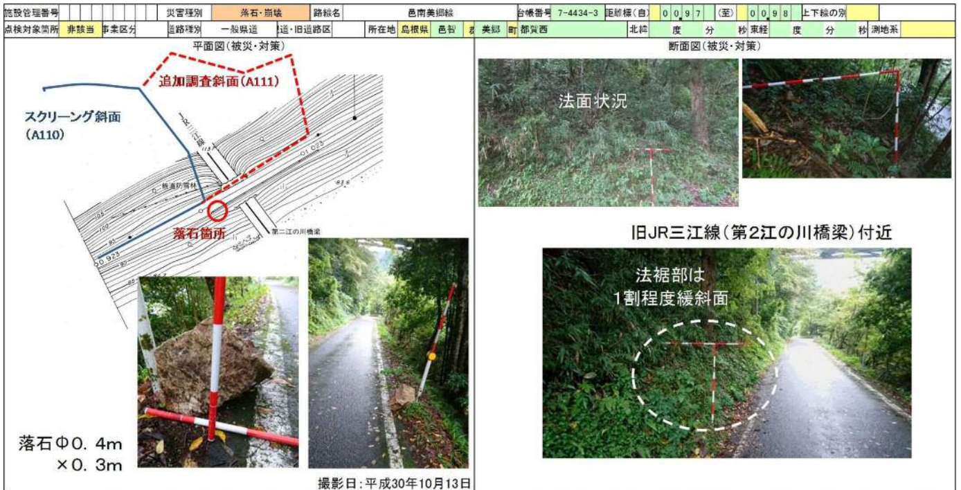
図-9 30 cm以上の落石発生時の記録事例
