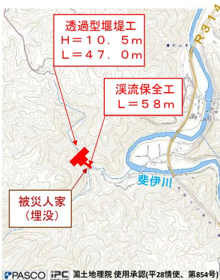
令和3年7月12日の梅雨前線豪雨により、山腹が崩壊して土石流が発生し、人家の埋没や市道の通行止めなどの被害も生じたことから、更なる土砂災害に対して緊急的に対処するため、砂防堰堤や溪流保全工を整備しており、**今年度中に完成する予定です。**
