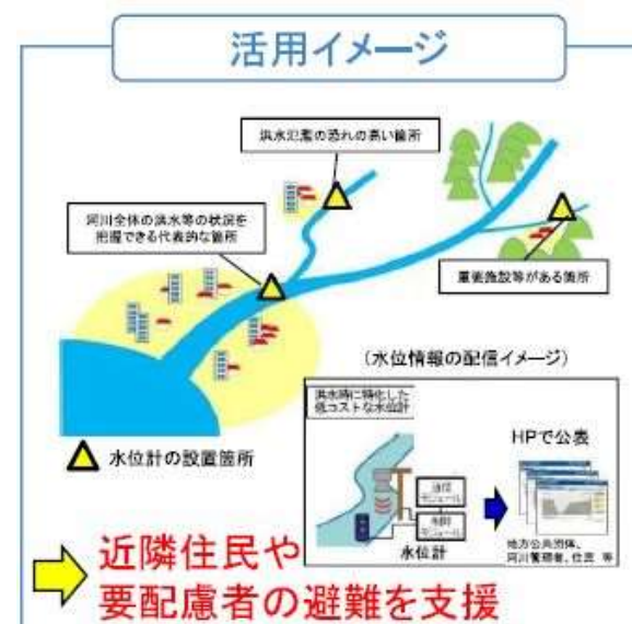
洪水に特化した低コストな水位計の設置例
