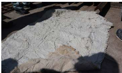
出火したものと同型のコンクリート養生マット （出火したマットは焼失）
