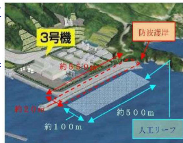
図：島根原子力発電所3号機 防波護岸
