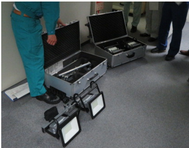
投光器一体型バッテリーの収納状況
