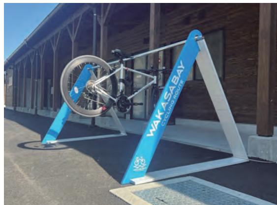
美浜町レイクセンターに設置された クリアランス金属で製造したサイクルラック 出典：経済産業省HP
