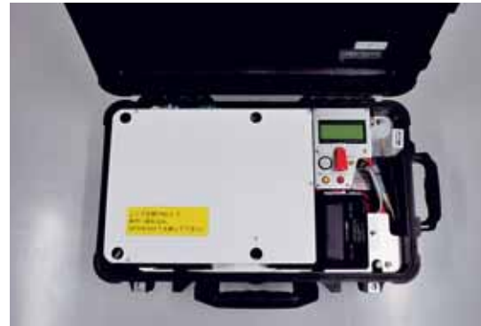
走行サーベイ用資機材のセット
