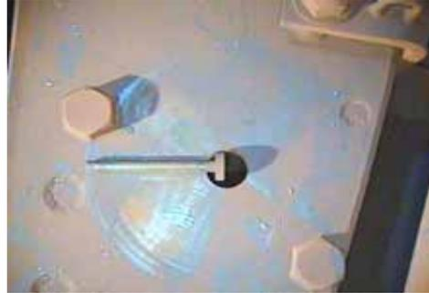
デフレクタが脱落したノズル
