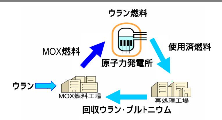
\*MOX燃料:ウラン・プルトニウム混合酸化物燃料(混合酸化物=Mixed Oxide)
