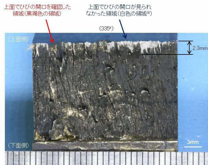
図1 破面形状の確認結果 (TP-1c)
