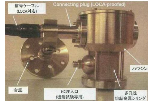
■ : 静的触媒式水素処理装置
