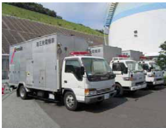
[写真①] 高圧発電機車
