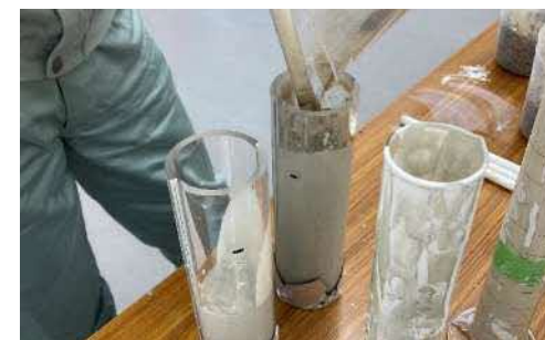
図5 供試体の作製状況
