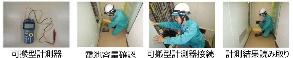
図3 可搬型計測器による計測風景
