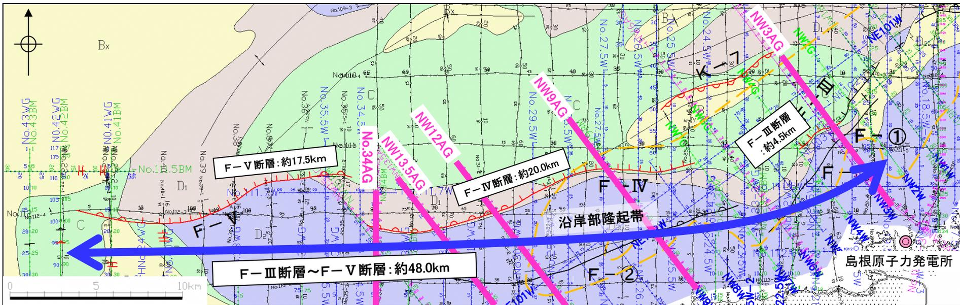
地質図に記載された断層線の端点は断層が確認される測線と確認されない測線との中点までを表示している。
