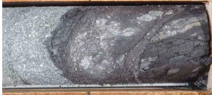
※深度78.70~78.75m付近の面構造の最浅部(黄丸)と破砕部の面構造の最浅部はコア周囲水平面上で約90°程度ずれた位置関係であったことから、走向はN89Eから90°右回転させた値、傾斜はコア観察の値(56°)とした。
