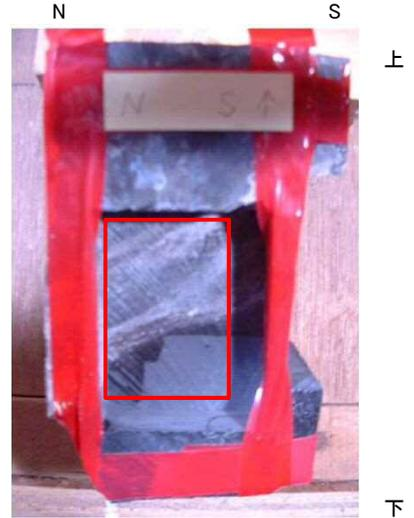
ブロック試料写真(平成15年採取) □ 薄片作成位置
