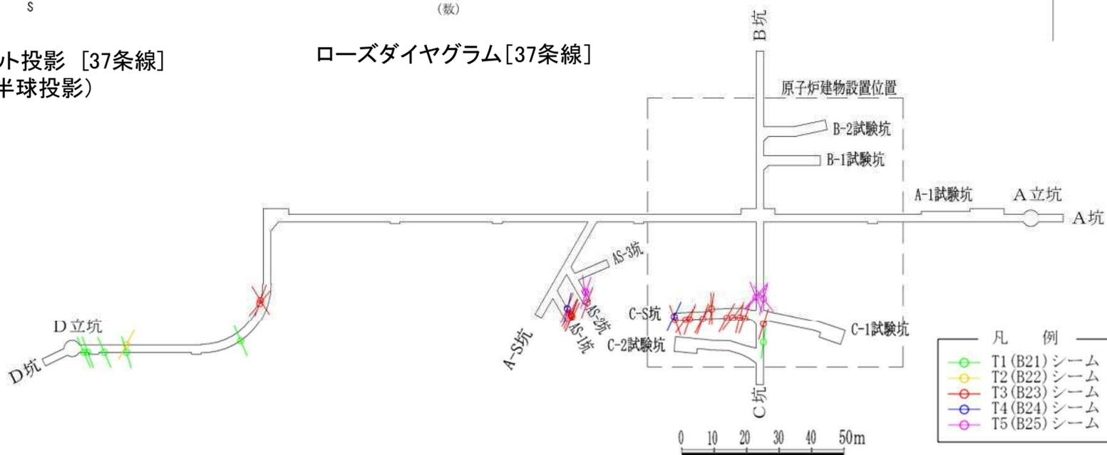
・シームの条線方向調査の結果, シームの最終変位方向は, 概ね南北方向であると考えられる。
