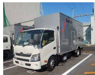
高圧発電機車
