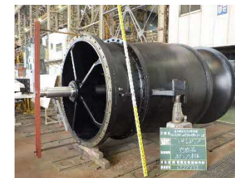
整備後の排水機
