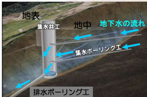
集水井工による排水のイメージ
