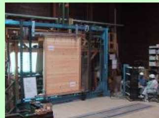
写真-2 異樹種3層パネルを利用した耐力壁の面内せん断試験 (広島県立総合技術研究所 林業技術センターにて実施)
