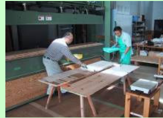
写真-1 集成接着工程
