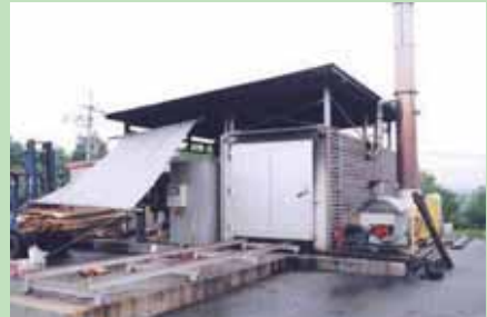
写真1 燻煙熱処理試験装置
