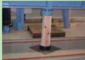
写真3 短柱の縦圧縮試験
