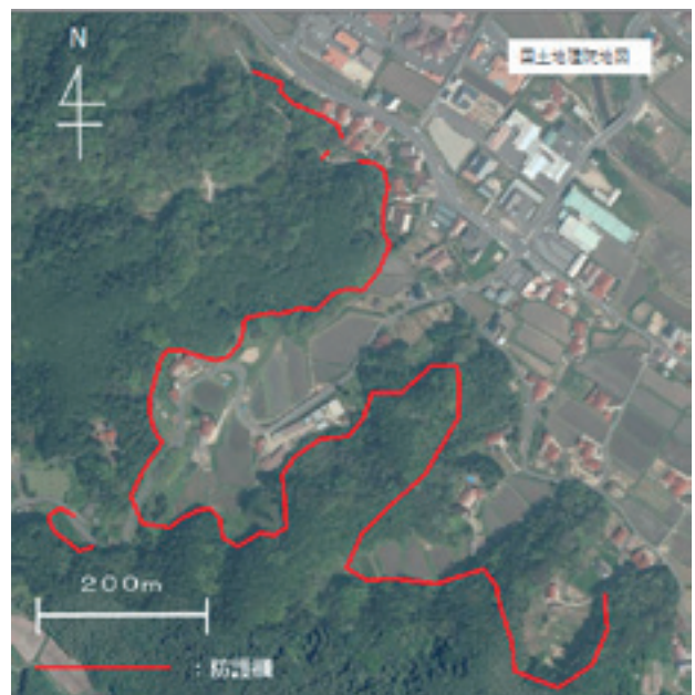
図3 C地区の防護柵の設置位置
