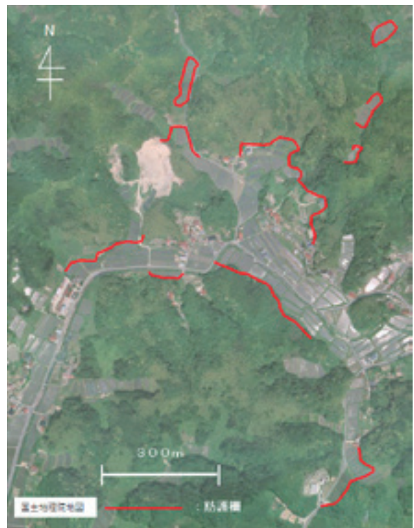
図2 B地区の防護柵の設置位置
