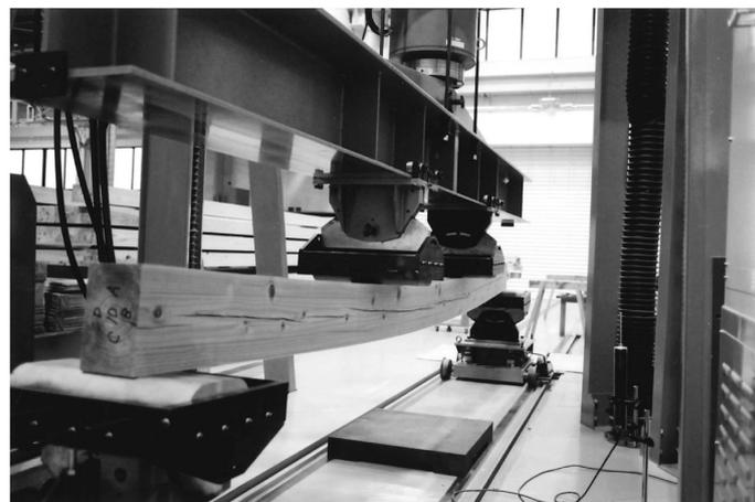
写真3 スギ平角試験材の実大曲げ試験（縦使い）
