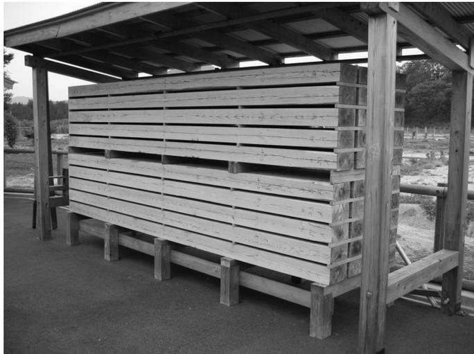
写真2 スギ平角試験材の天然乾燥
