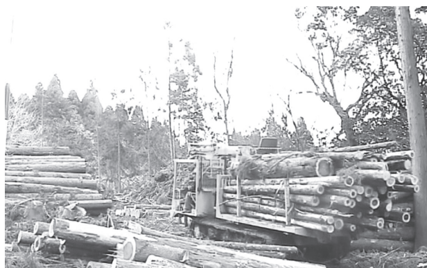
写真1 チップ用材(C材)の積載状況
