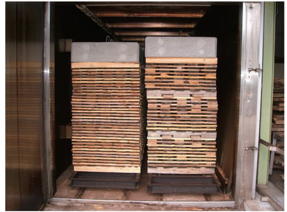
写真2 弥栄自治区内の木材加工事業所におけるコナラ板材の人工乾燥
