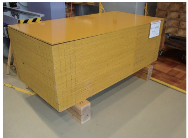
写真4 県内合板メーカーが試作したコナラスギ複合合板（左：構造用、右：型枠用）
