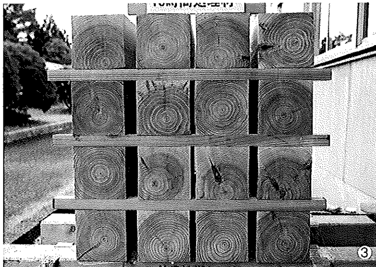
写真1 試験材と取り付けた熱電対（上段15，中段23，下段37時間乾燥試験材）
