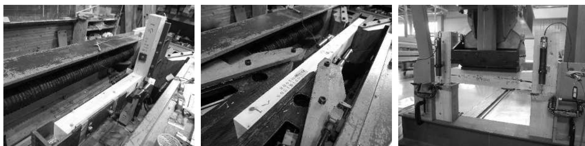
写真 1 接合部要素予備試験（左：柱－梁型，中央：継手型，右：梁－梁型）
