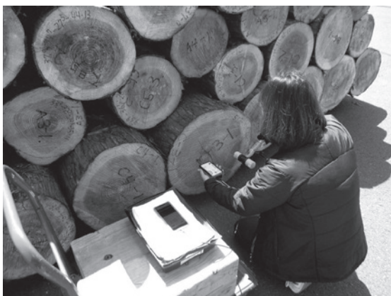
写真1 簡易型強度測定器によるはい積みしたスギ原木のヤング係数測定
