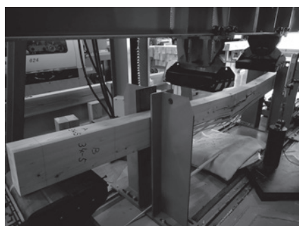
写真1 ヒノキ心持ち平角の曲げ試験
