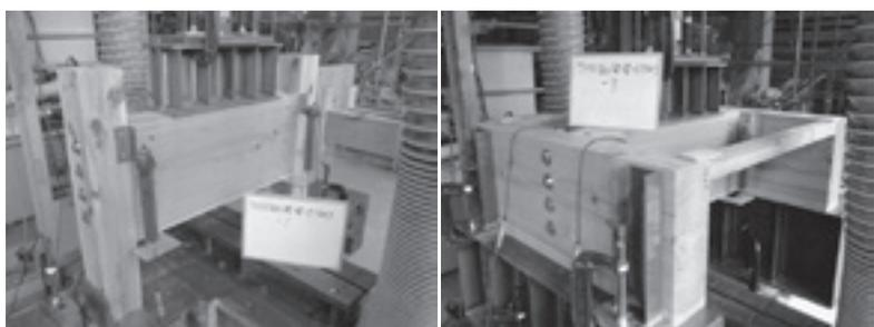
写真－2 スギ製材の仕口接合部のせん断試験
