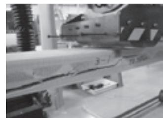
写真-8 曲げ破壊の状況
