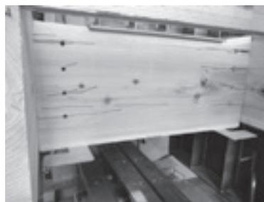
写真－5 仕口接合部で柱－梁型（左）と梁－梁型（右）の破壊例
