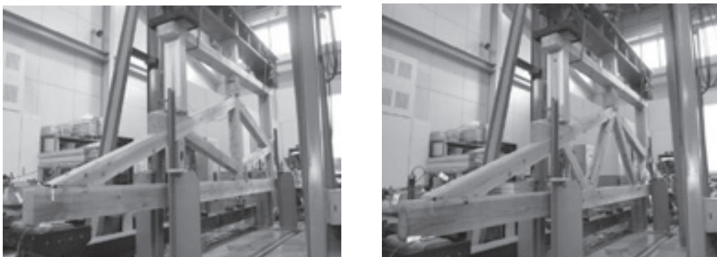
写真-1 スギ製材を用いてプレカットにより製造したハウトラス（左）とフィンクトラス（右）
