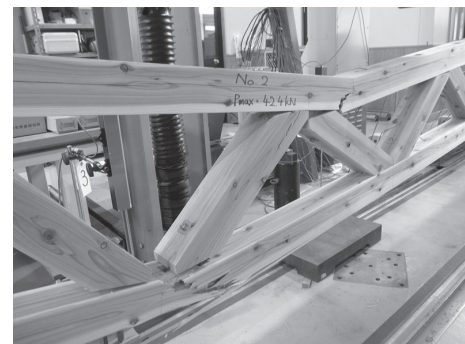
写真-4 部材接合部で生じた破壊
