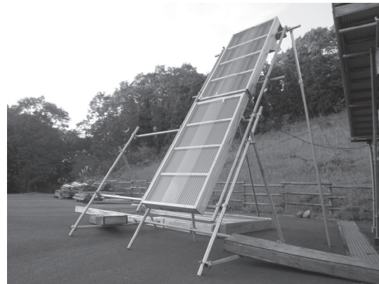
写真-1 集熱装置の設置状況
