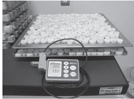
写真-2 養生中の試作埋木コマ
