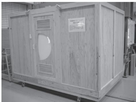
写真－1 床暖房熱耐久試験装置
