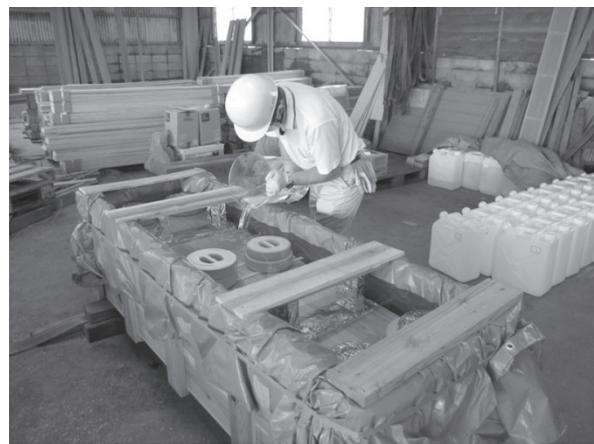
写真-4 注入槽への薬液の入れ込み
