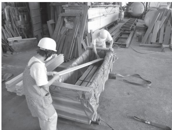
写真-3 薬液注入槽へのスギひき板の設置
