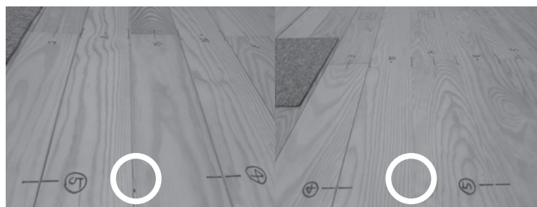
写真-3 特殊さね加工による視覚改善 (左：コントロール材，右：試験材)
