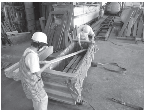
写真-3 薬液注入槽へのスギひき板の設置
