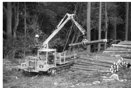
写真－2 フォワーダへの積み込み
