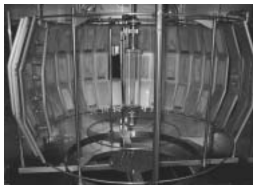
写真-1 促進耐候性試験の概要
