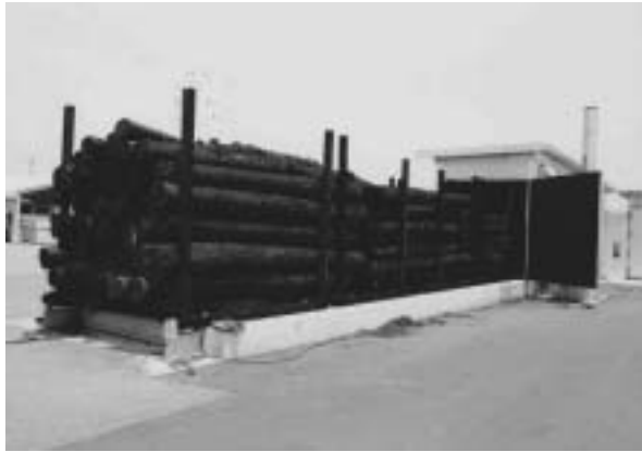
写真-1 燻煙熱処理後のスギ丸太
