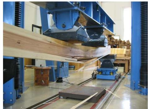
図3 実大曲げ強度試験
