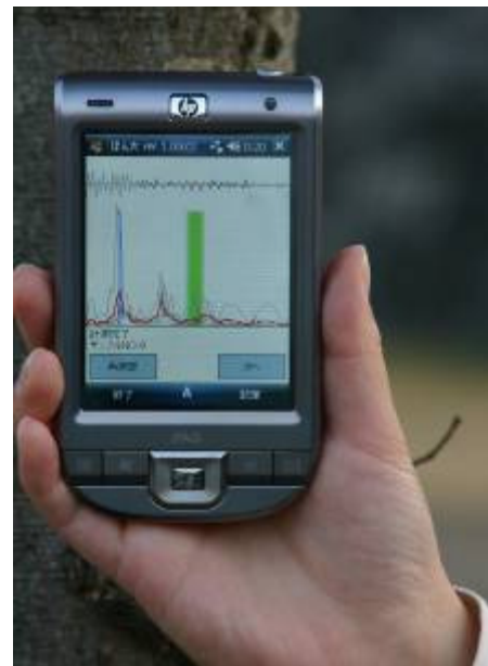
図-4 販売開始された簡易樹木腐朽診断装置 (愛称: ぽん太)。打撃されると共振周波数を自動的に読み取り、診断結果が即座に表示される。
