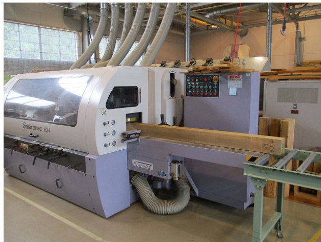
写真 8 モルダーによる修正挽き
