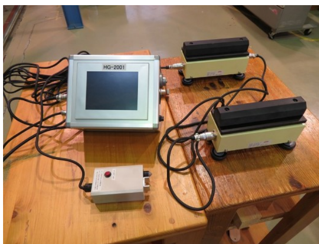
写真 10 打撃振動による機械等級区分装置
