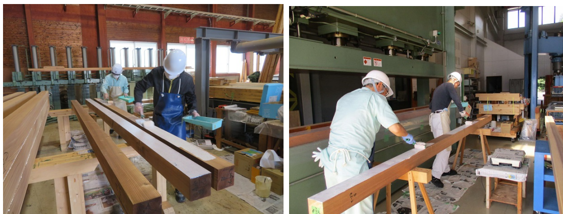
写真 14 ハンドローラーによる接着剤の塗布
