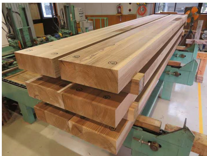
写真 18 仕上げ後の 3 層の接着重ね材
