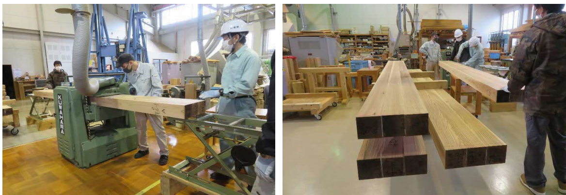
写真 17 自動一面かな盤による 3 層の接着重ね材の仕上げ
