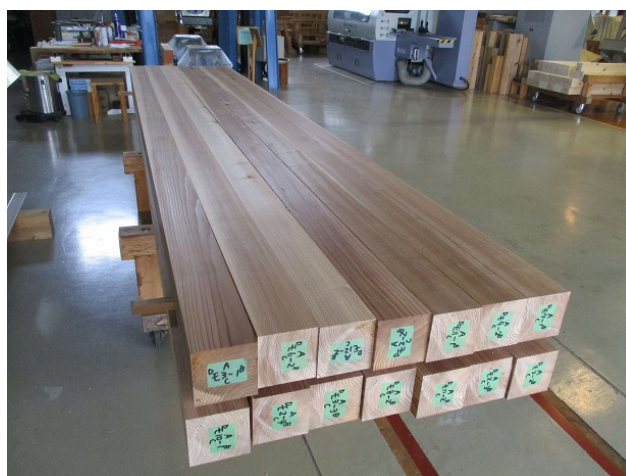
写真 9 修正挽き後の製材ラミナ
