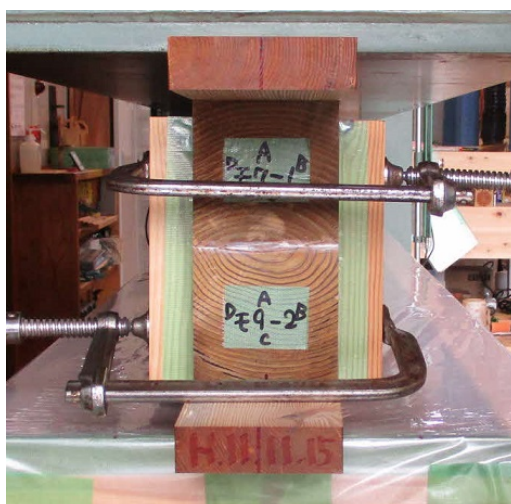
写真 20 圧縮中の 2 層の接着重ね材 G クランプはズレ止め
