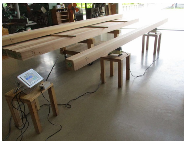
写真 11 打撃振動による縦振動ヤング係数の測定
