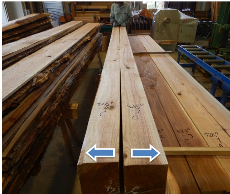
写真 4 製材時に曲がりが生じたスギ心去り正角 矢印：曲がり
