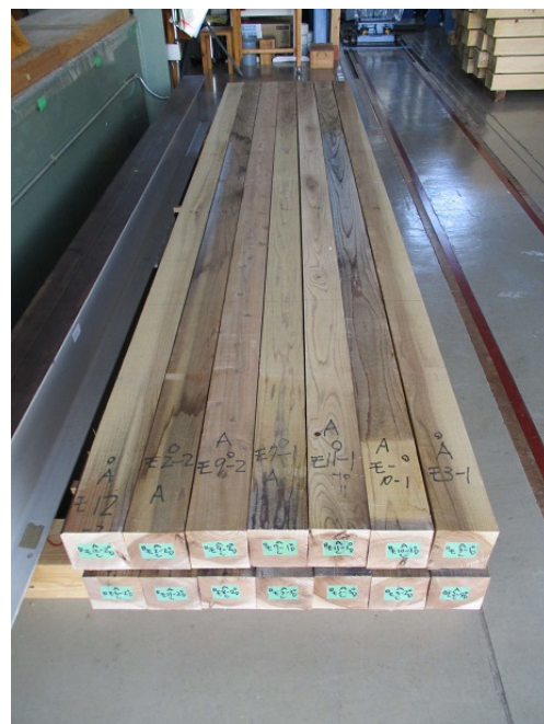
写真７ 養生後のスギ心去り正角
