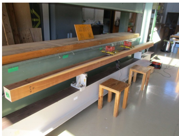
写真19 重錘法による製材ラミナの曲げヤング係数測定
