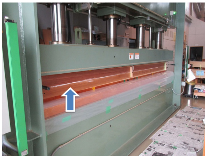
写真 15 2層の接着重ね材圧縮時の接着剤のはみ出し 矢印：接着剤のはみ出し
