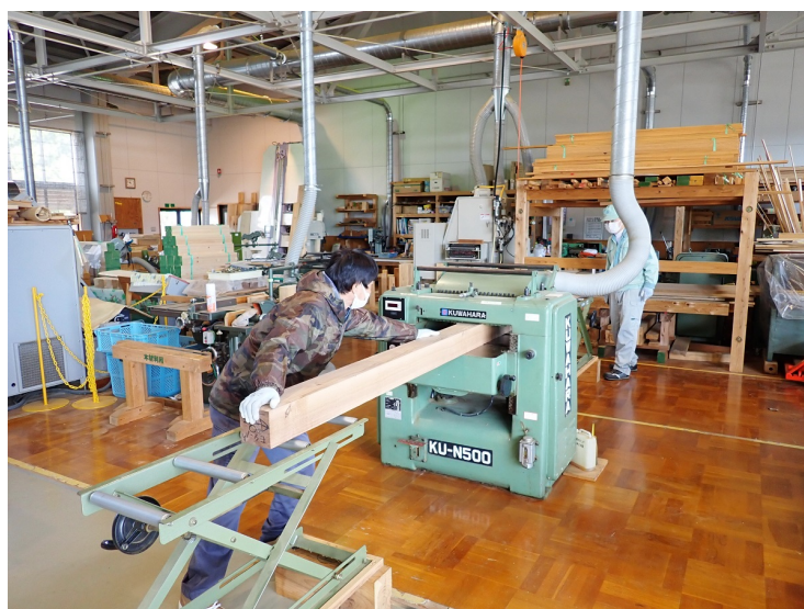
写真 12 自動一面かな盤による接着前加工
