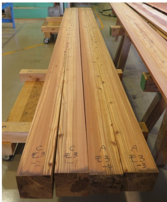
写真 1 スギ大径材から 4 丁取りした心去り正角
