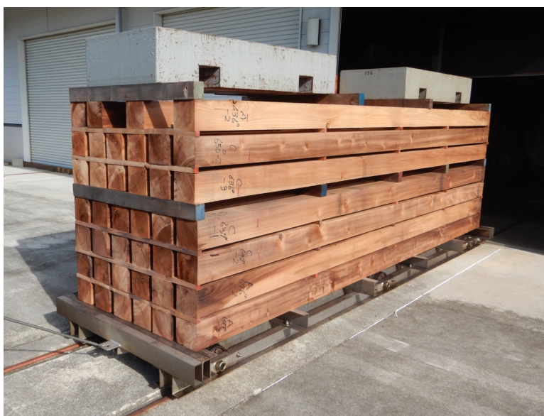
写真 6 台車上に積載したスギ心去り正角と重石
