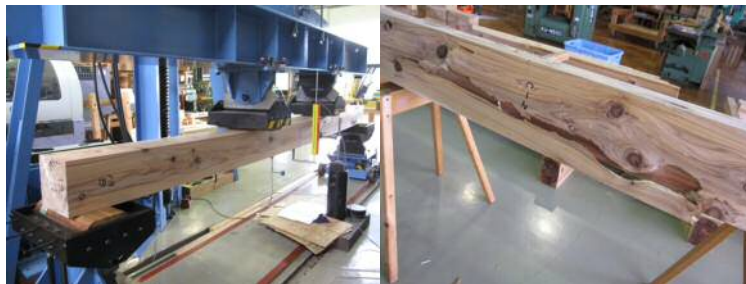
図2 210mm角の曲げ試験(左)と曲げ破壊例(右) Note. 写真(右): MOE 5.88 kN/mm 2 、MOR 21.4 N/mm 2 .
