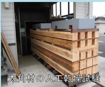
太角材の人工乾燥試験
