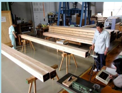
スギ製材の強度測定
