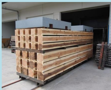
スギ太角材の乾燥試験
