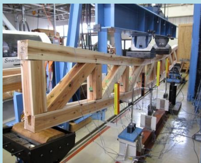
梁トラスの曲げ破壊試験
